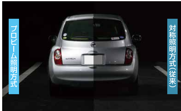
プロビーム照明方式と対称照明方式の違い
