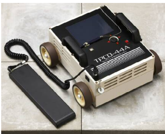
測定器外観(230W×11H×300D)重量4.9kg(本体のみ)
