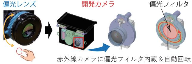
〈検証実験〉 Jソフト上で熱反射を自動除去
